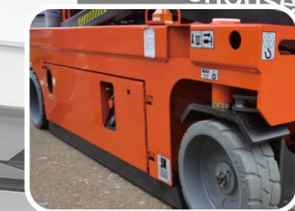
포트 홀 보호 시스템 (플랫폼 상승시 자동 작동:1.2M)
